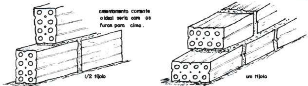
Figura 1 - Execução de alvenaria utilizando tijolos furados.
